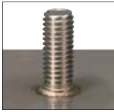
Kleiner, gleichmäßiger spritzerfreier Schweißwulst
